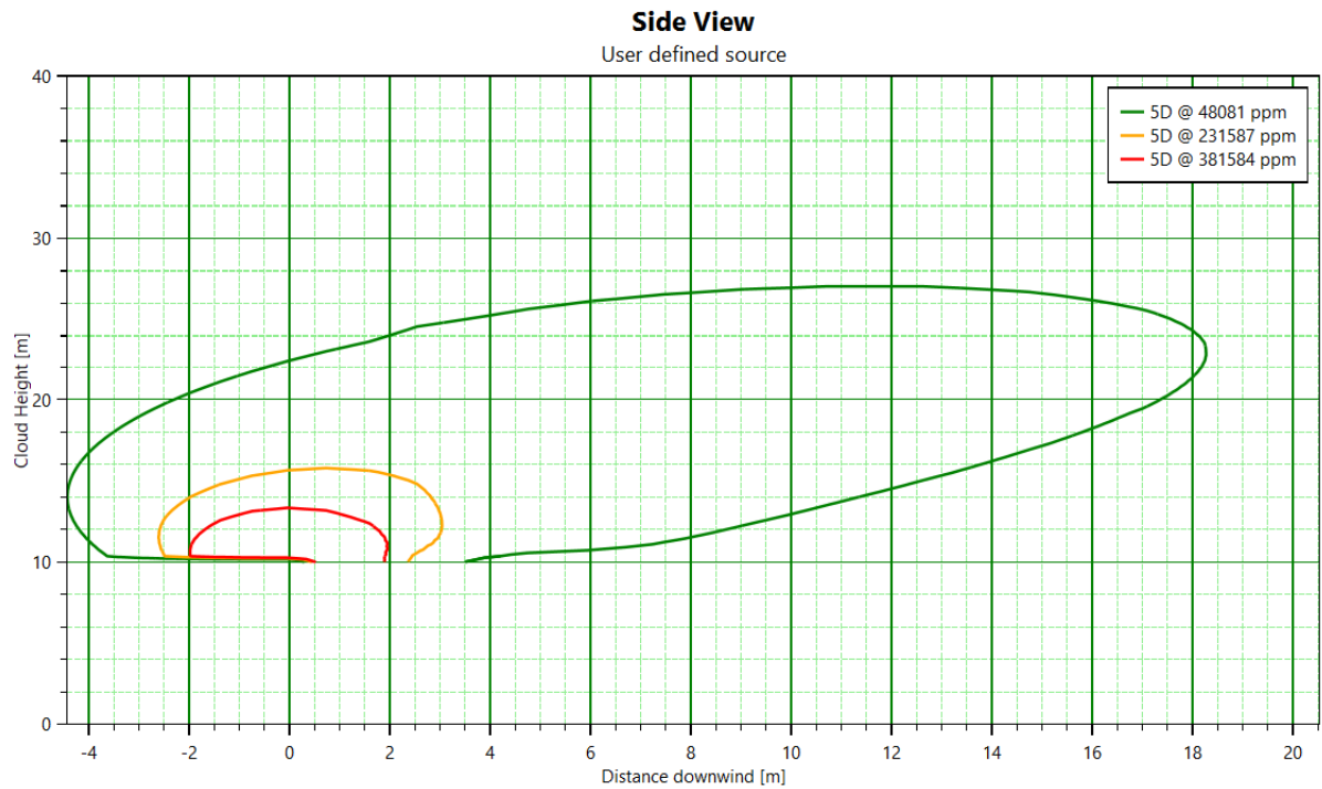
Figure 30 : Toxicité des fumées liées à l'incendie du silo de charbon/coke moulu, condition 5/D
